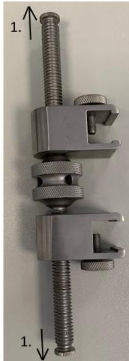
2. Die großen Feststellschrauben an beiden Knochenhalteklammerhaltern lösen.
