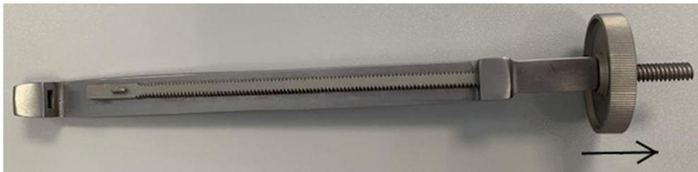
3. Die Gewindestange aus dem Bandspanner ziehen.
